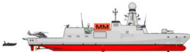
Figura 4 - Rendering del OEZPV, lo scafo richiama una Classe Comandanti allungata e le sovrastrutture sono affini alla classe Al Zubarah, con un'ottimizzazione degli scarichi dei motori termici principali per lasciare ampi spazi liberi sul cielo dell'hangar e per la "Tuga Container".
